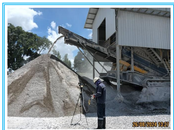
รูปที่ 4.3-10 แสดงการตรวจวัดค่าความทึบของฝุ่นละออง (Opacity) บริเวณปลายสายพานลำเลียง วันที่ 26 สิงหาคม 2567
