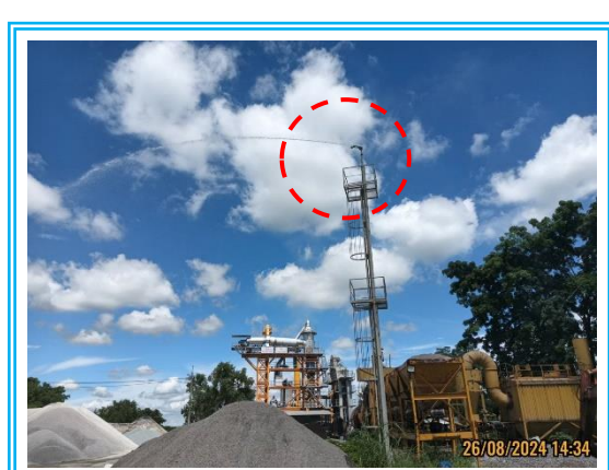
รูปที่ 3-9 สเปรย์น้ำบริเวณที่เกิดฝุ่นละออง
