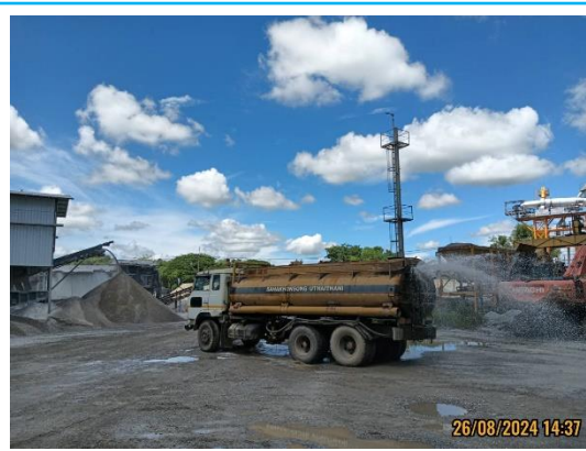
รูปที่ 3-10 ฉีดพรมน้ำบริเวณพื้นที่โรงโม่หินลานกองแร่
