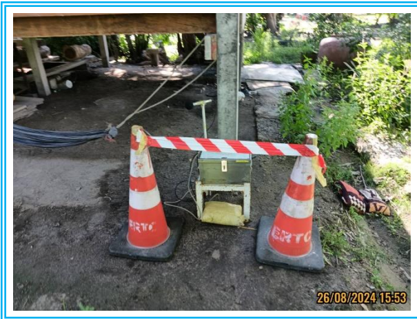
รูปที่ 4.3-18 แสดงการตรวจวัดความสันสะเทือน บริเวณบ้านร่องไม้แดง วันที่ 26 สิงหาคม 2567
