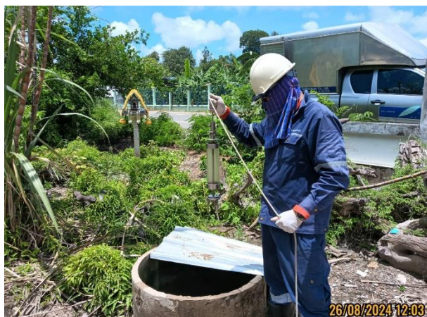
รูปที่ 4.3-32 แสดงการเก็บตัวอย่างเพื่อตรวจวัดคุณภาพน้ำใต้ดิน บริเวณน้ำบ่อต้นบ้านหนองบัว วันที่ 26 สิงหาคม 2567
