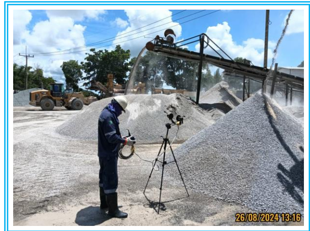
รูปที่ 4.3-8 แสดงการตรวจวัดค่าความทึบของฝุ่นละออง (Opacity) บริเวณตะแกรงคัดขนาดหิน วันที่ 26 สิงหาคม 2567
